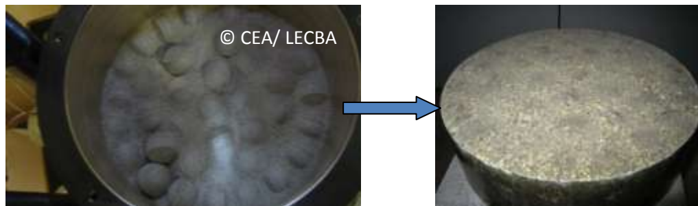
Figure 2 : Illustration du caractère hétérogène et évolutif de la bentonite : assemblage granulaire sec de pellets initial (billes fortement compactées de diamètre 32 mm, et de concassé de pellets de granulométrie comprise entre 0 et 2,5 mm dans les proportions 70/30 : photographie de gauche) ; bentonite après hydratation (photographie de droite).
